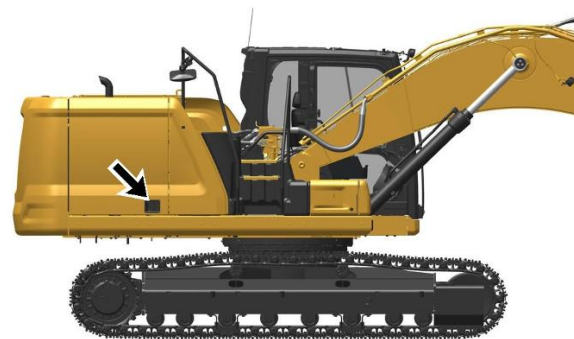
Рисунок 6 g06182545 Обеспечивает доступ к масляному фильтру двигателя, отверстию для отбора проб моторного масла и выносному щупу. Кроме того, в этом отсеке расположен гидронасос, топливные фильтры, топливозаправочный насос, сливной клапан топливного бака и смотровой указатель гидробака.
